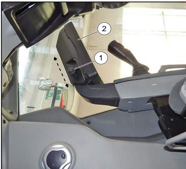
Afbeelding 56: Stelknop voor hoogte-instelling van het display
