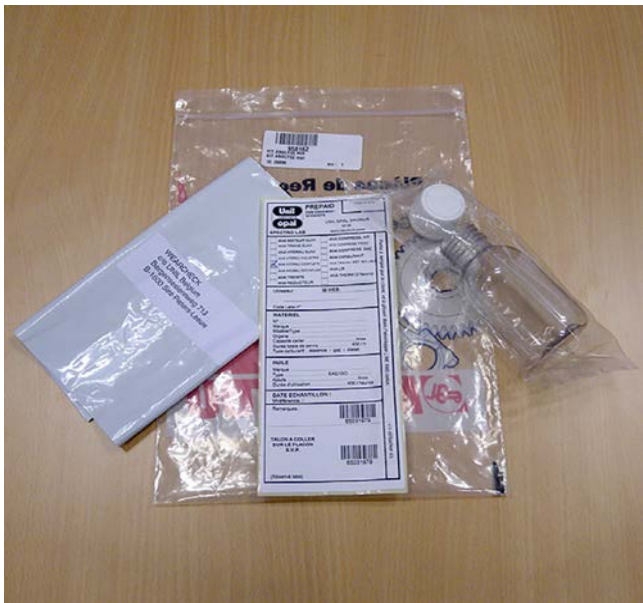
Afbeelding 173: Op vervuiling van de hydraulische olie controleren
